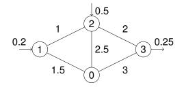
4 ロ ト 4 回 ト 4 直 ト 4 直 ト 重 の Q で 42/48 *Problem*: Compute the PTDF from bus 1 to line 2-3 when 0 is the hub node
